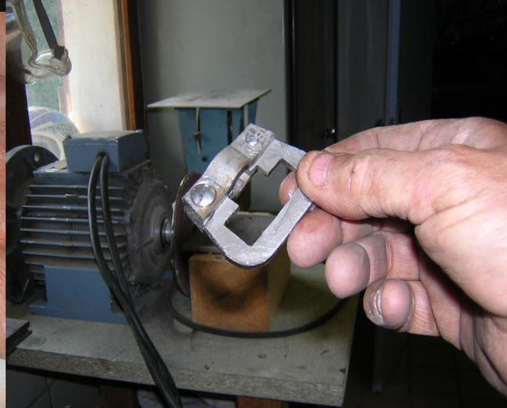
15: Meulage de finition et des arrondis
