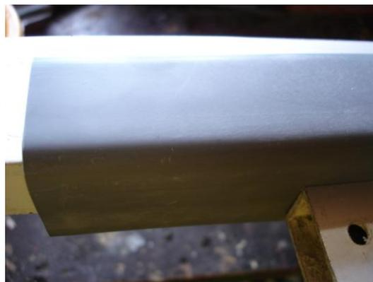
J'ai utilisé un nez de marche en P.V.C, vendus dans les magasins de bricolage (6 Euros pour 1,70 M) pour réaliser une protection d'étrave, les petits stries antidérapants ont été supprimés avec une ponceuse excentrique et un grain de 120 puis j'ai utilisé un grain de 400 à la main à sec puis un grain de 600 à l'eau et au savon afin de le rendre le plus lisse possible.
