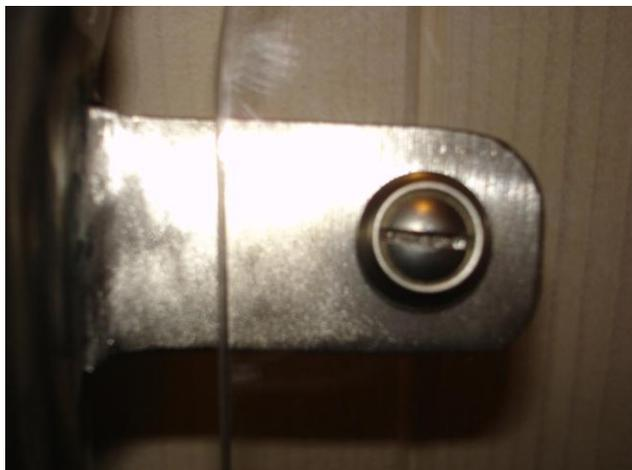
La fixation est réalisée avec des vis inox de 6 mm et des rondelles creuses, un joint de caoutchouc est positionné entre le Styrolass et la patte afin d'éviter les vibrations dans le pare brise.
