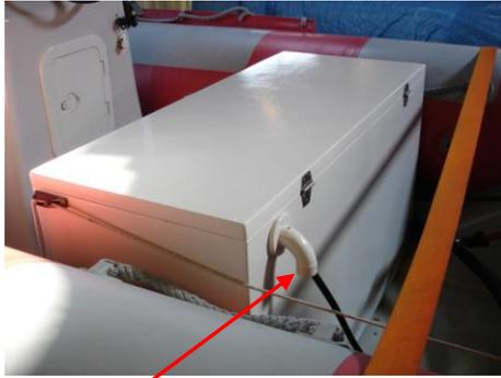
Le passage de l'alimentation de carburant est réalisé avec un coude de cuivre de diamètre 28mm.
