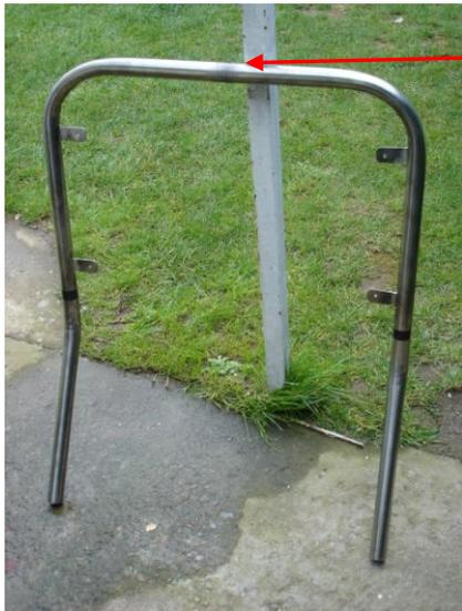
Les soudures ont été réalisées à l'arc avec des électrodes inox.
