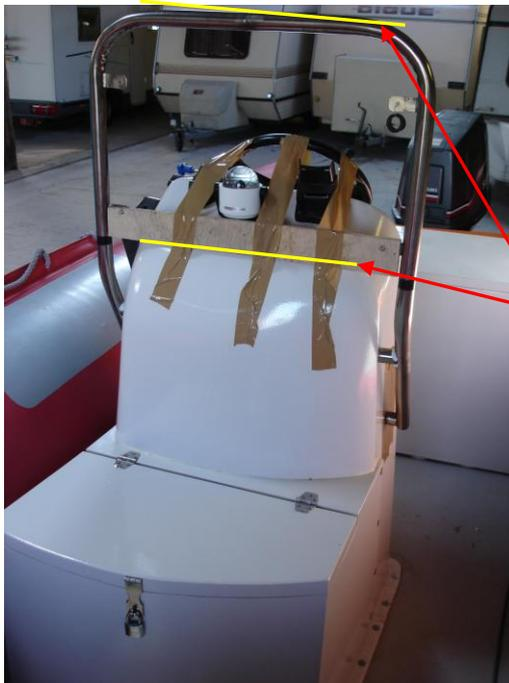
La hauteur entre le dessus de la console et le haut de la main courante est maintenant de 40 cm.
