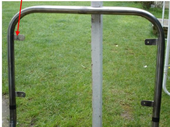
la largeur intérieure de la main courante est de 58 cm, celle de la console de 51 cm, ce qui me laisse 7 cm pour souder deux entretoises de chaque côté afin d'écarter le tube de 3,5 cm de la console de chaque côté afin de posséder une poignée de par et d'autre de la console ...
