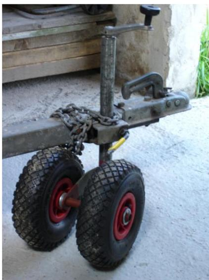
J'ai gardé le même support auquel j'ai supprimé la roue de plastique centrale et remplacé par un axe plus long sur lequel j'ai accouplé deux roues gonflables de 260 mm. Ce montage a l'avantage de rouler plus facilement et ne s'enfonce pas dans le sable.
