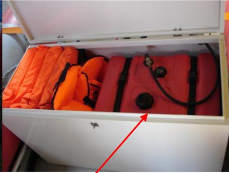
Un rebord est réalisé en c.p. de 5 mm sur le tour du coffre afin de le rendre totalement étanche.
