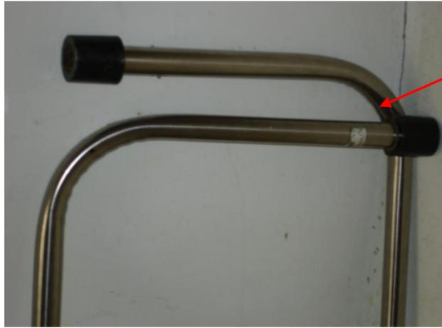
Les cintrages ont été réalisés avec une cintruse hydraulique et les tubes ont été remplis de sables afin de supporter le cintrage.
