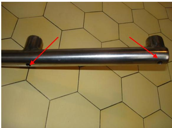
Les entretoises sont soudées et des **trous de 8 mm** sont percés dans le tube afin de recevoir des vis inox de 8 X 80 pour la fixation à la console.
