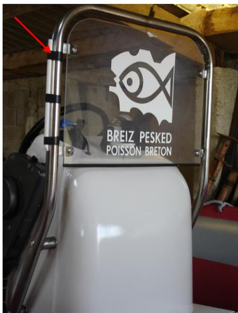
Puis la main courante est montée sur la console et **un petit tube de P.V.C.** est ajouté afin de recevoir le pavillon Alpha.
