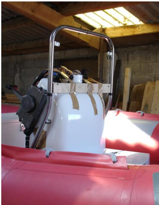
La main courante est positionnée provisoirement sur la console afin de contrôler les équerrages.
