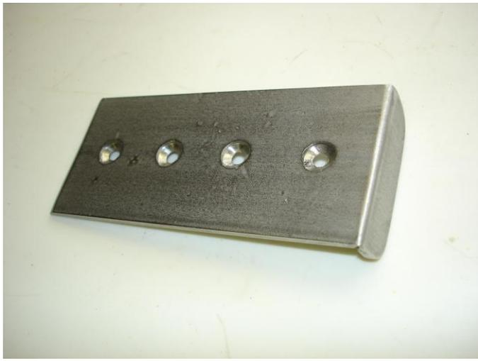
Puis j'ai percé quatre trous de 5 mm et je les ai chanfreinés afin de passer des visse inox de 5x35mm.
