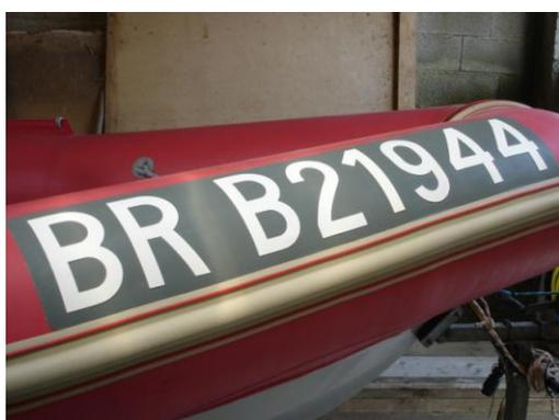
J'ai collé une bande de pvc sur les boudins avec une colle bi composants puis, collé sur cette bande des lettres spéciale pneumatique.
