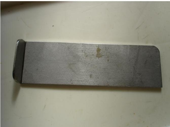
J'ai utilisé un morceau d'inox de 4 mm d'épaisseur que j'ai replié à une extrémité,
