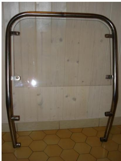
Un pare brise est découpé dans du Styroglass de 5 mm d'épaisseur et fixé sur les pattes de fixation.
