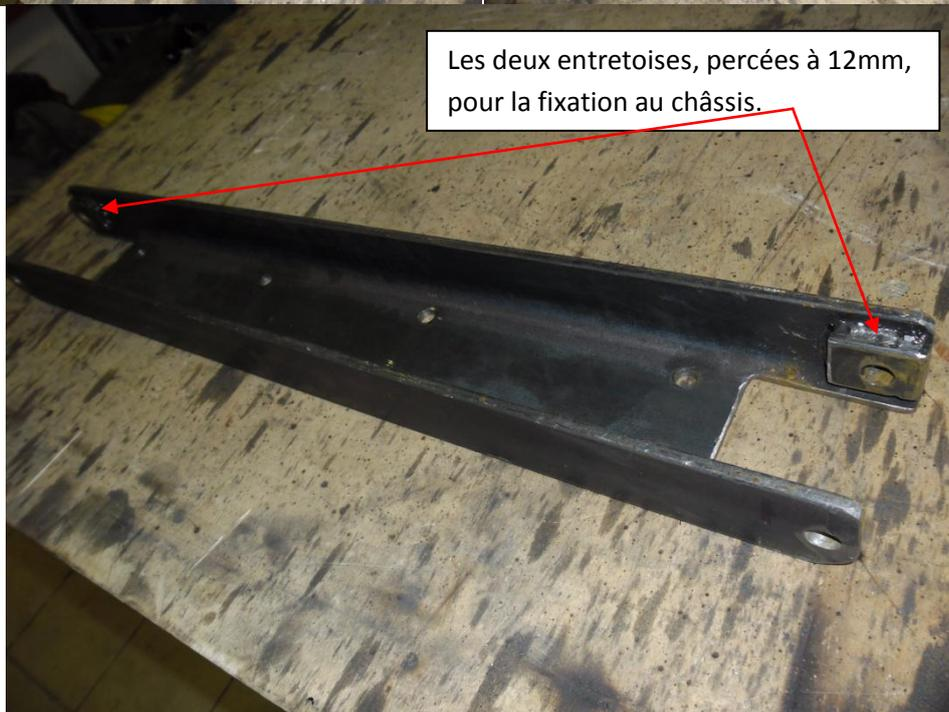
Je réalise un support intermédiaire avec une base plate de 5mm d'épaisseur percée de 8 trous de 12mm, deux carrés de 50 mm de largeur et 3 mm d'épaisseur sont soudés et renforcés d'un fer plat de 5mm sur le dessous et d'equerres de renfort , un carré de 30X30 maintient l'écartement.
