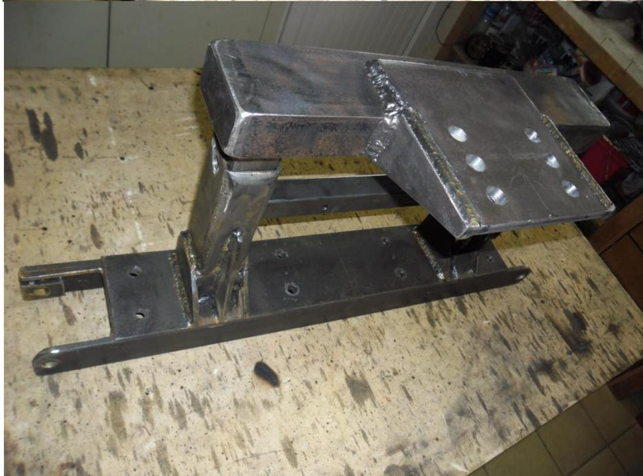
Deux goupilles sont réalisées avec des boulons de force de 12mm de diamètre et de 100mm de longueur dont les filetages sont coupés , percés à 3mm pour la mise en place de goupilles inox.
