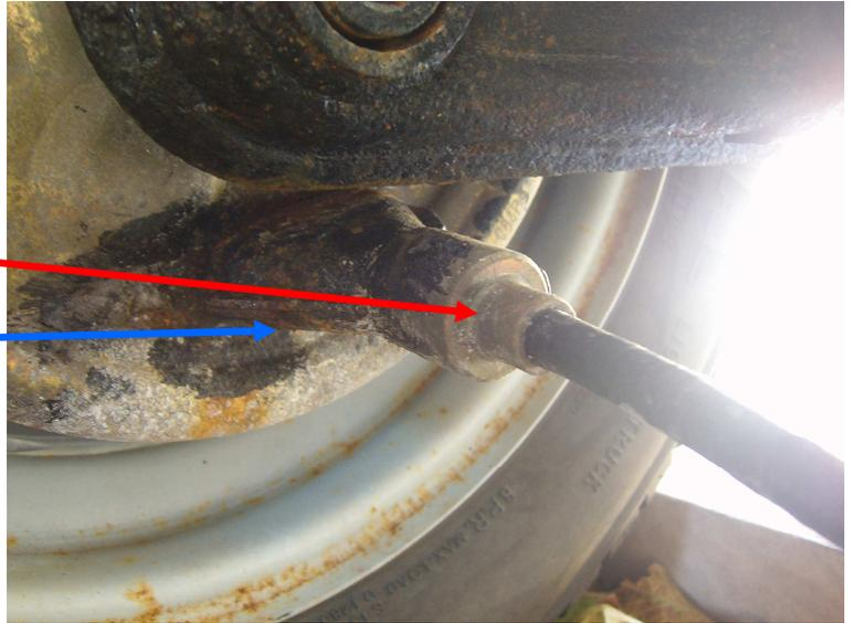
Il faut **tirer** sur le câble pour reculer le cylindre.
