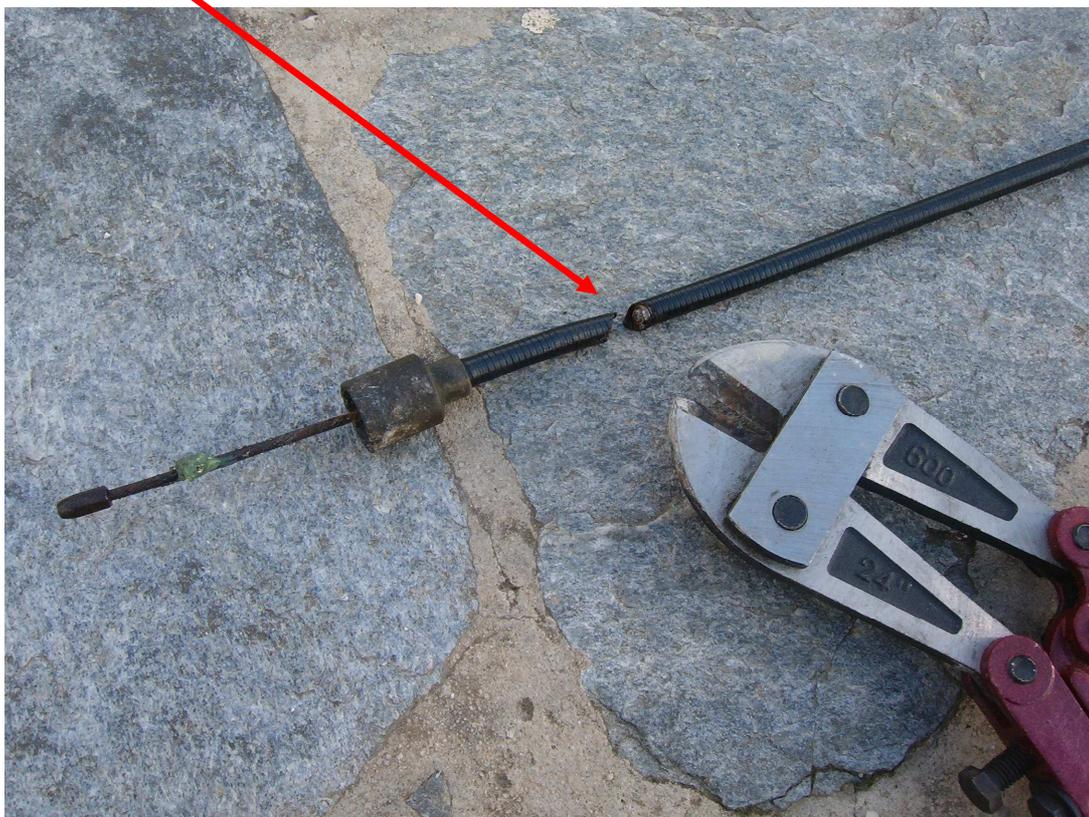
La photo montre de la graisse sur le câble. Il ne faut pas en mettre (Cf. explication plus loin dans le texte). Il s'agit de la graisse que j'avais mis dans le mécanisme des tambours qui est venue en retirant le câble.
