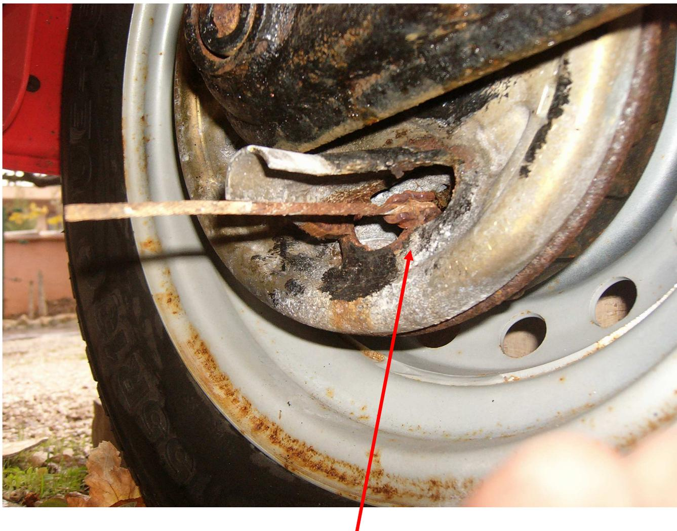
Noter au passage **l'emboîtement du bout du câble** (la forme en **olive**) qu'il suffit de pousser vers la roue puis d'incliner sur le coté pour le sortir totalement.
