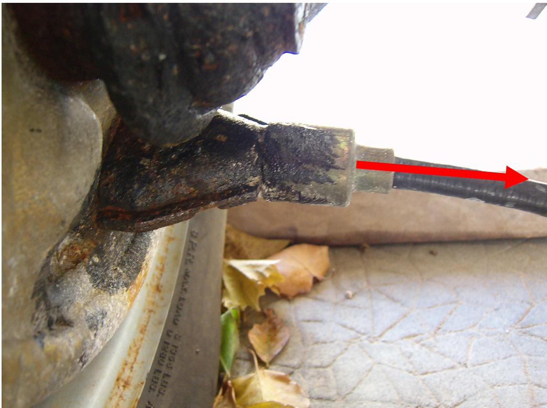
A ce moment la **partie mobile** de la pièce trapézoïdale doit tomber par terre. Si vous n'arrivez pas à reculer le câble, coupez le avec une grosse pince au plus près du moyeu.
