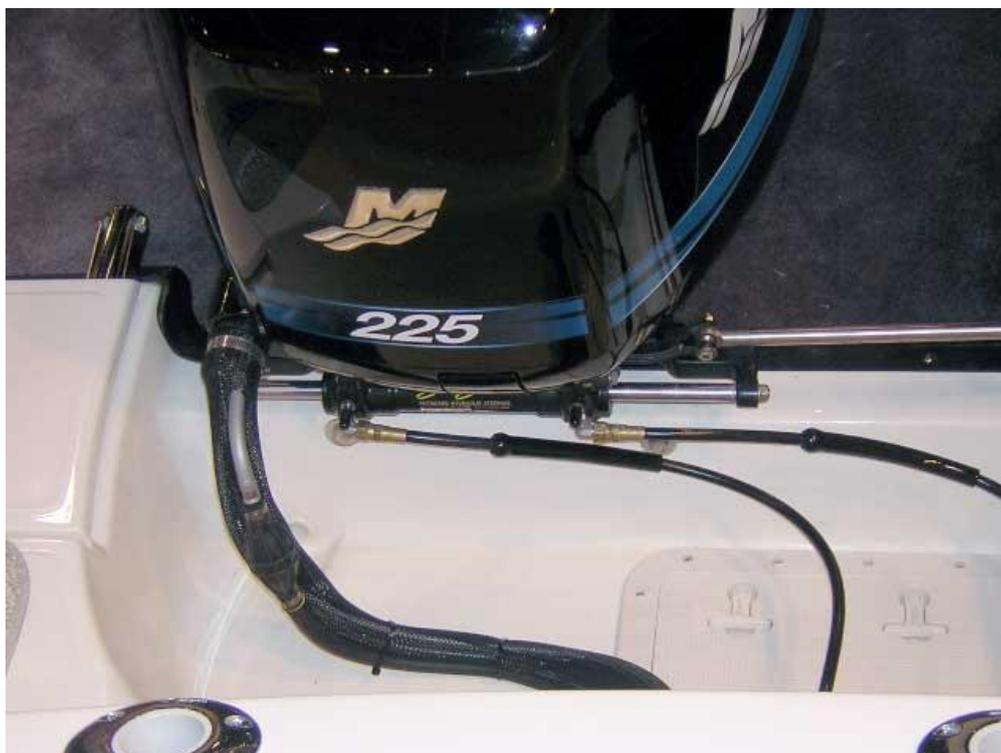
*Sur cette installation pré équipée la poire d'amorçage est placée près du moteur. Elle est orientée verticalement pour faciliter l'amorçage.*
